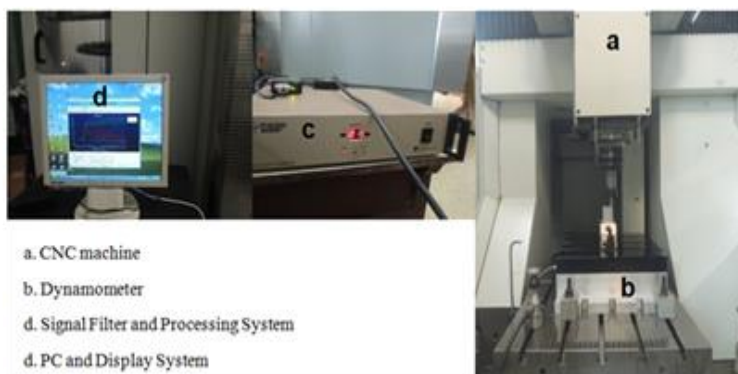
Hình 3. Thiết lập thí nghiệm đo lực cắt trong quá trình phay
