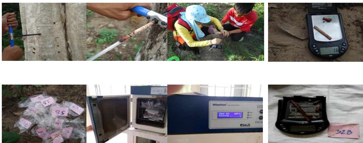
Hình 1: Khoan cây theo hai hướng Bắc, Nam; Đo chiều dài, đường kính mẫu gỗ, cân và lấy mẫu gỗ tươi; Sấy mẫu và cân mẫu khô
